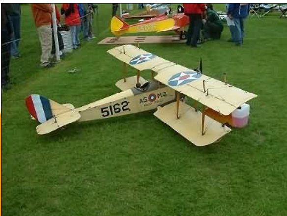
Die große Jenny von Hans Amman Patmax 60ccm 4T / 3,32m Spwt.
